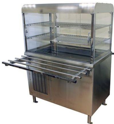
Прилавок предназначен для непродолжительного (до четырех часов) хранения и раздачи охлажденных напитков, салатов, кисломолочных продуктов и других блюд, требующих хранения в охлажденном состоянии. Прилавок изготавливается в климатическом исполнении ОМ категории размещения 4 по ГОСТ 15150, для эксплуатации при температуре окружающего воздуха от 0 до 45°C и относительной влажности до 80±3 % при температуре 40±2°C
