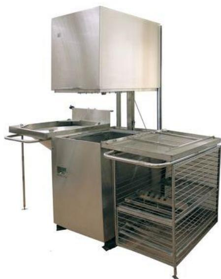
Машина посудомоечная купольного типа судовая предназначена для мытья глубоких и мелких тарелок, суповых мисок, кружек металлических и пластмассовых, столовых приборов и подносов размером не более 530×325 мм с применением моющих средств.
